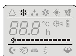
Чтобы оптимизировать работу кондиционера, установите температуру (1), скорость вращения вентилятора (2) и направление воздушного потока (3), нажимая кнопки, указанные на иллюстрации.
