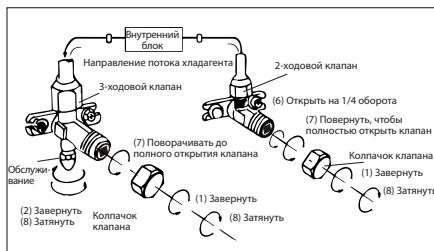
1. Отверните и снимите колпачки с 2- и 3-ходового клапанов.
